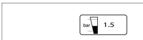
Fig. 52 Presiunea instalației indicată pe afișaj
